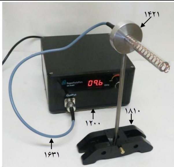
شکل ۶: نحوه اتصال آنتن هلیکال به مولد سیگنال مایکروویو با استفاده از کابل فرکانس بالا
